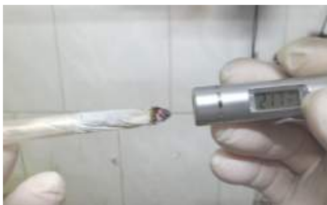
Fig. 3.21.- Medición de temperatura de combustión de cigarrillo de marihuana, el lector marca 217 °C.
