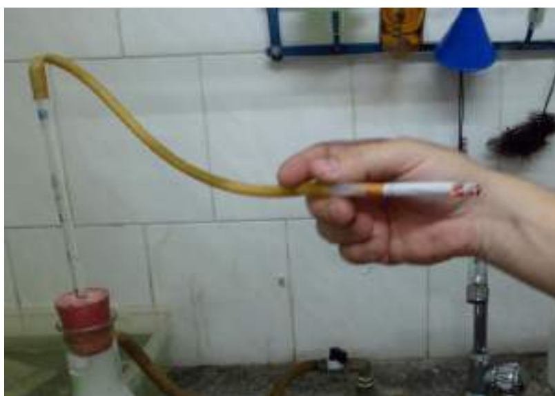
Fig. 3.16.- Combustión de cigarrillo de tabaco; succión realizada mediante bomba de vacío (izq).
